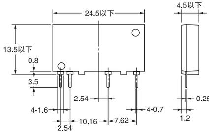
印刷基板加工图 (BOTTOM VIEW)
