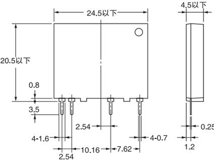
印刷基板加工图 (BOTTOM VIEW)
