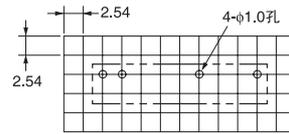
端子配置/内部连接图 (BOTTOM VIEW)
